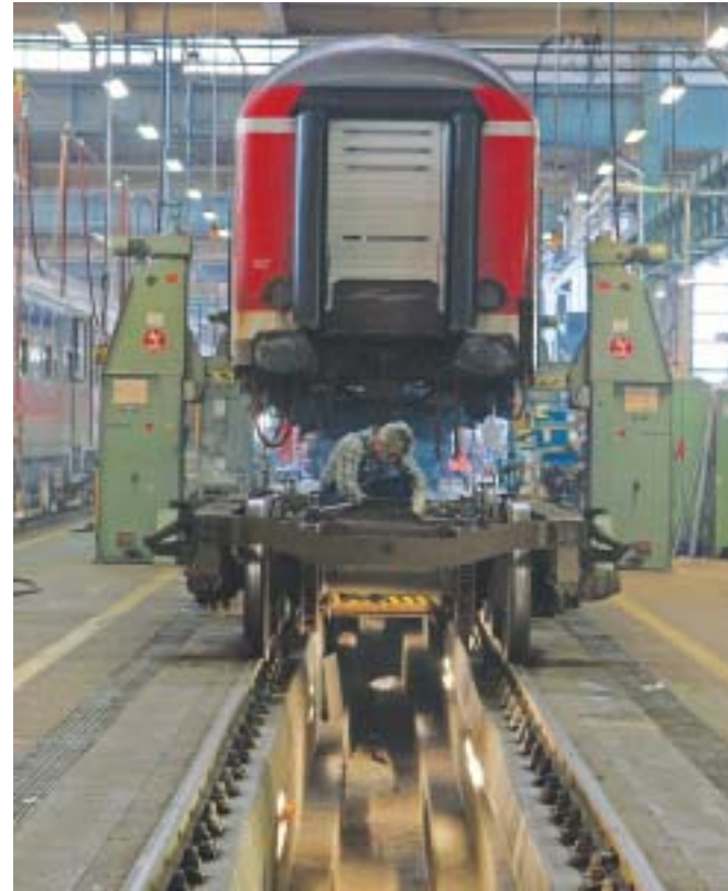
Ein Bild, das in wenigen Jahren Seltenheitswert haben wird: In Pasing erhält ein modernisierter „Silberling“ ein neues Drehgestell. 2008 sind bayernweit noch 400 solcher Waggons im Einsatz. Sie werden in den nächsten Jahren durch Doppelstockwagen und Elektrotriebwagen ersetzt. Foto: Ch. Grimm
